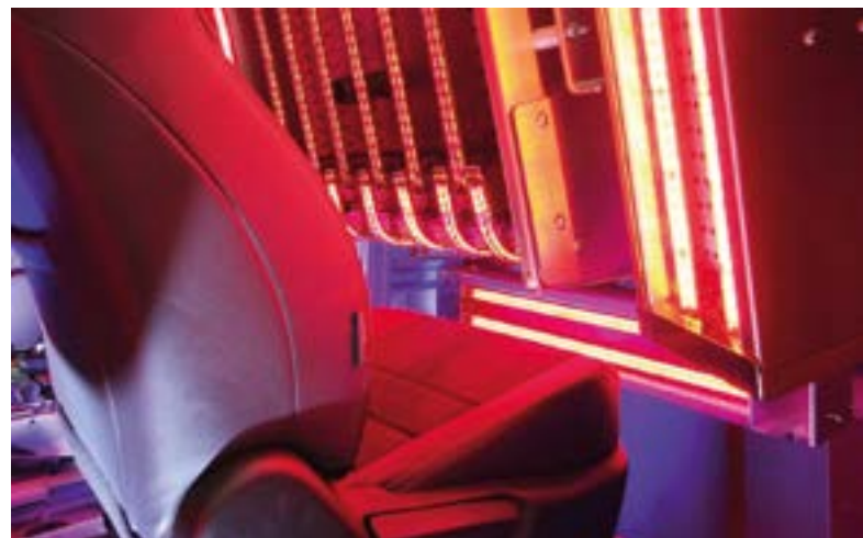
Infrarot-Systeme sparen Energie und Zeit bei der Fertigung von Auto-Innenverkleidungen. Copyright Heraeus Noblelight 2017
